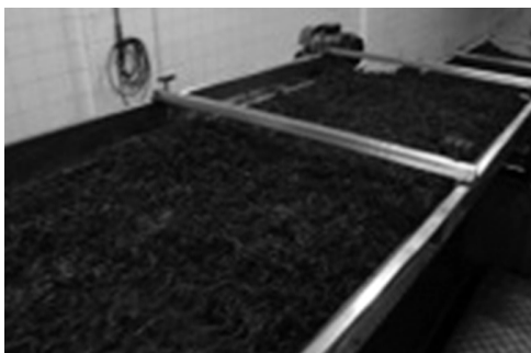
④ローラーブレイカーにかけ茶葉をほぐし、発酵へと進む
